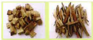
木質バイオマス燃料用として再資源化
